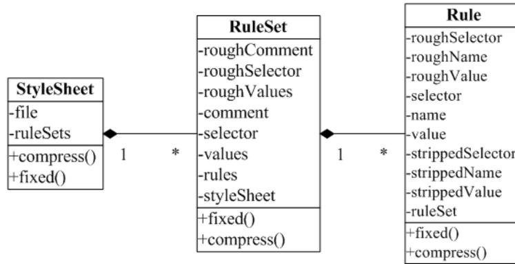
每一个实体类中都包含 compress 和 fixed 两个方法,前者用于生成压缩后的代码,后者用于生成修复后的代码。
