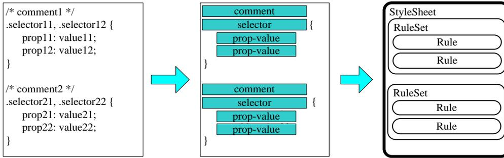
在解析完成之后,StyleSheet/RuleSet/Rule 等实体类中保存了 CSS 解析过程中的原始代码和清理后的代码两部分信息,前者用于检查代码风格,后者用于检查取值。
