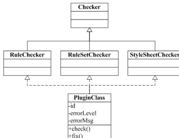
CSSCheckStyle 的所有与 CSS 检查、修复有关的功能，都将通过插件的形式来完成。插件类 PluginClass 有以下几个约束：
